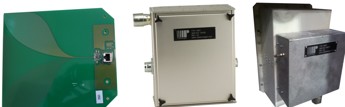
Figur 2. Sensorn består av a) två Vivaldi-antennerna och b) Wideband Radar Transceiver, WRT. c) Utvecklat antennhus för bättre signal, noggrannhet och styrka.
