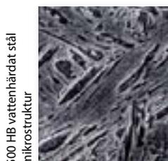
500 HB vattenhärdat stål mikrostruktur
