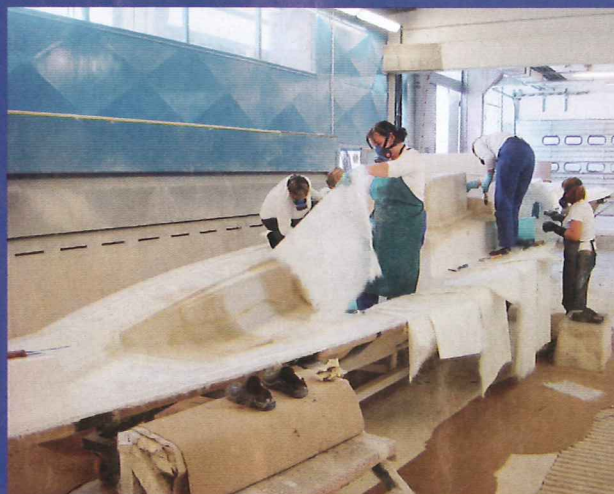
Skrovet till Elan 210 vacuumsugs, medan däck (bilden) handupp-läggs av flinka kvinnor på varvet i Slovenien.
