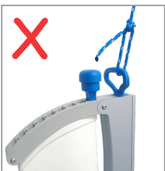
[bild 24] Knyt inte fast säkerhetslinan i låshandtaget
