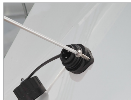
[bild 15] Skruva fast kontakten med två träskruvar
