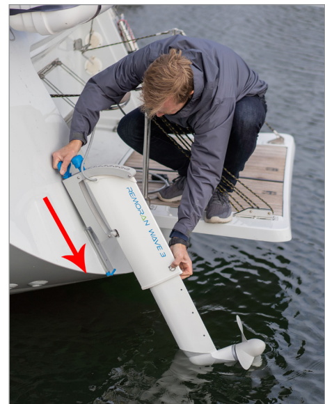
[bild 27] Placera den utvändiga enhetens stomme i den övre änden av skenan och skjut ned den längs skenan.
