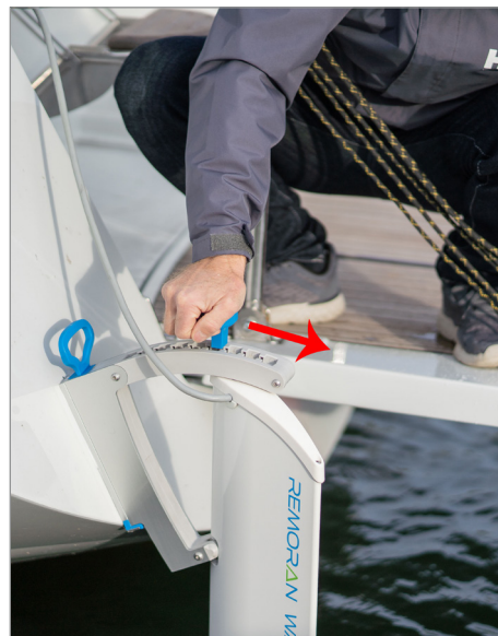
[bild 29] Ställ in den utvändiga enhetens vinkel så att den står rakt i förhållande till vattenytan
