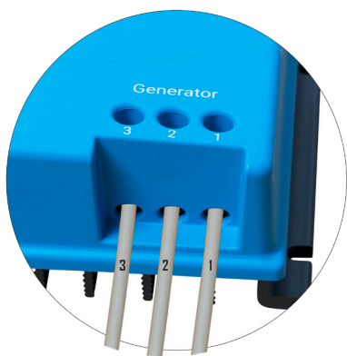
[bild 22] Koppla generatorledarna till laddaren så att ledarnas nummer motsvarar numreringen av skruvkontaktarna på laddaren.
