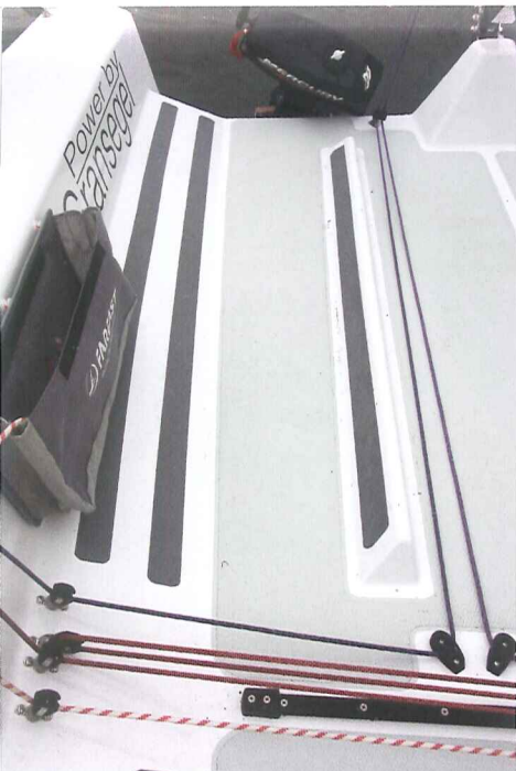
FOTLISTER: I cockpitdørken er det støpt inn fotstøtter.
